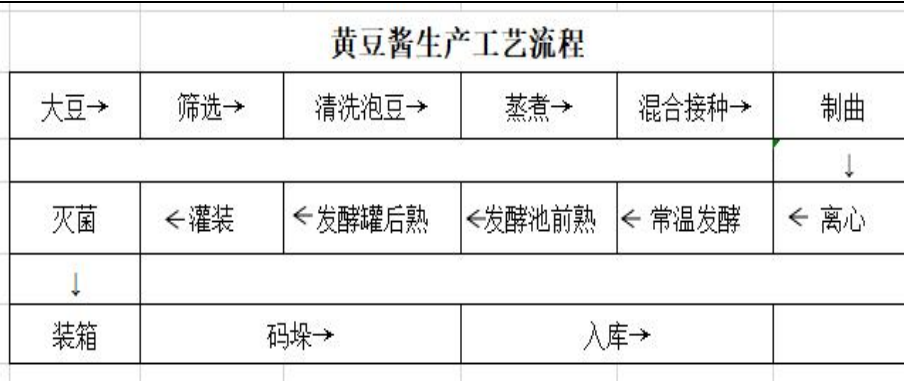
图 3—2 黄豆酱生产工艺流程
